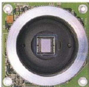
Modulo telecamera CCD B/N da 1/3" con buona definizione e sensibilità. Risoluzione: 400 linee; otturatore: Auto iris. Ottica e apertura angolare in funzione dell'obiettivo montato, attacco standard C/CS. Alimentazione: 12 V.
