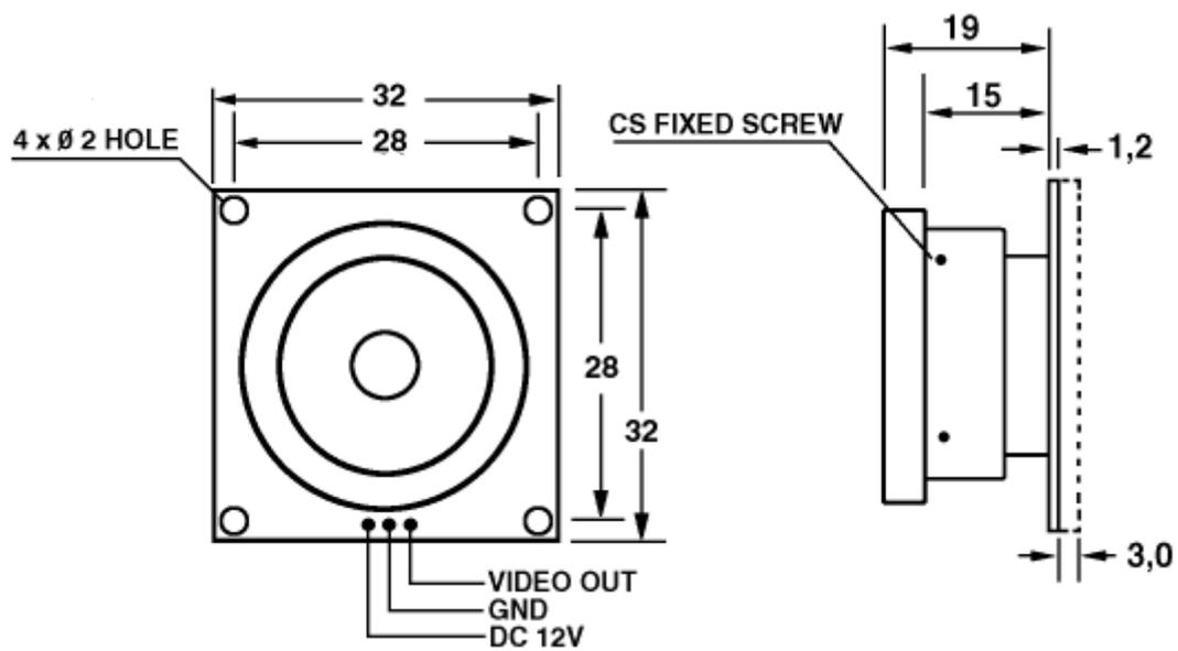
Misure in millimetri.
