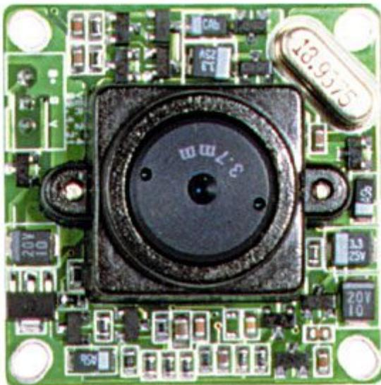
Modulo telecamera CCD B/N da 1/3". Risoluzione: 400 linee; sensibilità: 0,5 lux; otturatore: Auto iris. Ottica pin hole 3,7 mm, apertura angolare 90°. Alimentazione: 12 V.
