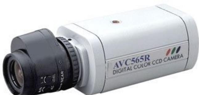
Telecamera professionale CCD a colori racchiusa in contenitore con attacco dell'obiettivo di tipo C o CS (t adattare). Elemento sensibile: CCD 1/3"; risoluzione: 350 linee TV; sensibilità: in funzione dell'obiettivo. telecamera non comprende l'obiettivo.
