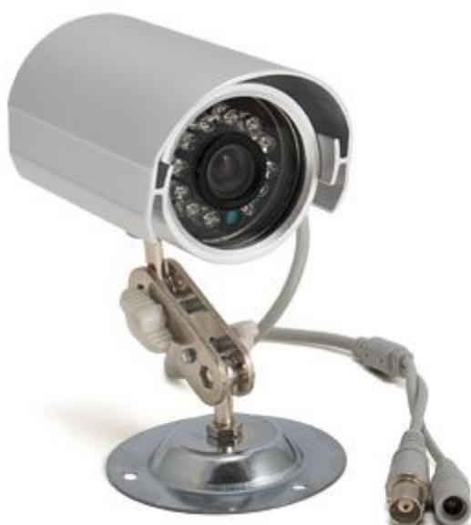
Telecamera con sensore Sharp CCD da 1/4" a colori, resistente alle intemperie (livello di protezione IP65) che consente riprese all'esterno senza dover ricorrere agli appositi contenitori a tenuta stagna. Dispone di 12 LED infrarossi che si attivano in presenza di scarsa luminosità che ne permettono l'utilizzo anche in condizioni di buio assoluto. La telecamera viene fornita completa di staffa di fissaggio in metallo e di adattatore di rete.
