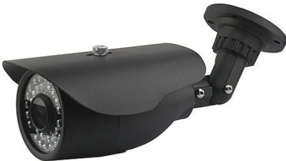
Telecamera con sensore CMOS da 1/3" a colori, resistente alle intemperie (livello di protezione IP66) che consente riprese all'esterno senza dover ricorrere agli appositi contenitori a tenuta stagna. Dispone di 24 LED infrarossi che si attivano in presenza di scarsa luminosità che ne permettono l'utilizzo anche in condizioni di buio assoluto. La telecamera viene fornita completa di staffa di fissaggio in metallo. Alimentatore di rete non compreso.
