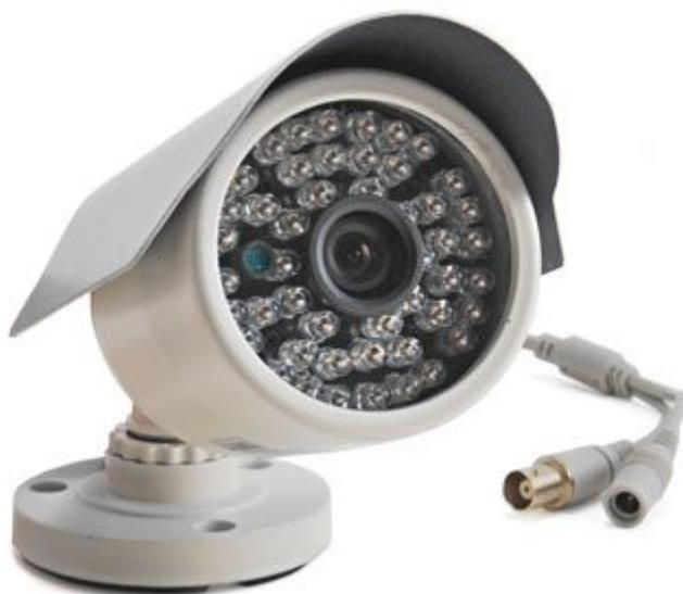
Telecamera con sensore CMOS da 1/3" a colori, resistente alle intemperie (livello di protezione IP65) che consente riprese all'esterno senza dover ricorrere agli appositi contenitori a tenuta stagna. Dispone di 48 LED infrarossi che si attivano in presenza di scarsa luminosità che ne permettono l'utilizzo anche in condizioni di buio assoluto. La telecamera viene fornita completa di staffa di fissaggio in metallo e di adattatore di rete.
