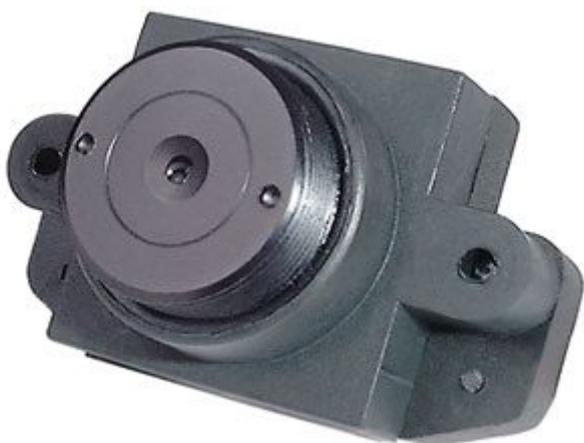
Piccolissima telecamera a colori ad alta risoluzione. Realizzata in tecnologia CMOS, presenta una risoluzione di 380 linee TV e misura appena 17,30 x 28 x 18 mm. Ottica 4,3 mm / F2.0, alimentazione da 5 a 12 Volt.
