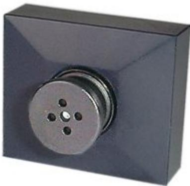
Telecamera a colori di piccolissime dimensioni facilmente occultabile dietro ad un vestito grazie al particolare obiettivo a forma di bottone. Sensore CMOS di nuova concezione realizzato con tecnologia CCIQ (Challenge CCD Image Quality) che consente di ottenere una qualità di ripresa simile a quella dei sensori CCD. Controllo delle funzioni a microcontrollore con sensore di luminosità/guadagno a 16 zone. Alimentazione 5 - 12 volt.
