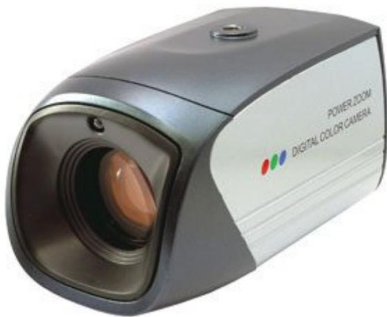
Compatta telecamera professionale day & night con sensore CCD 1/4" SONY. Dotata di Zoom ottico 30x, messa a fuoco automatica, risoluzione 480 linee TV, sensibilità 0,5 lux, menu OSD. Controllo delle funzioni tramite tastiera sul lato posteriore della telecamera o tramite cavo (RS485). Alimentazione 12 Vdc - 3,6 W (alimentatore non compreso).
