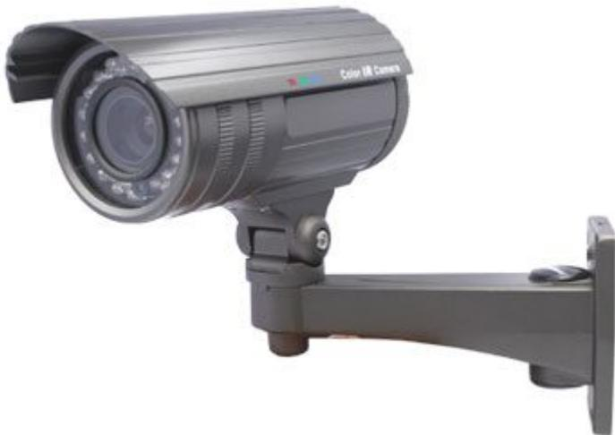
Telecamera professionale day & night con CCD da 1/3" SONY. Dispone di ottica varifocal da 4 a 9 mm con regolazione manuale, risoluzione 480 linee TV, menù OSD, motion detection (64 blocchi), funzione privacy zone (4 zone), grado di protezione IP66 e robusta staffa con regolazione su 2 assi (Pan e Tilt). I 36 LED IR di cui è dotata garantiscono una visione notturna fino a 20-30 metri. Alimentazione 12 Vdc (alimentatore non compreso).
