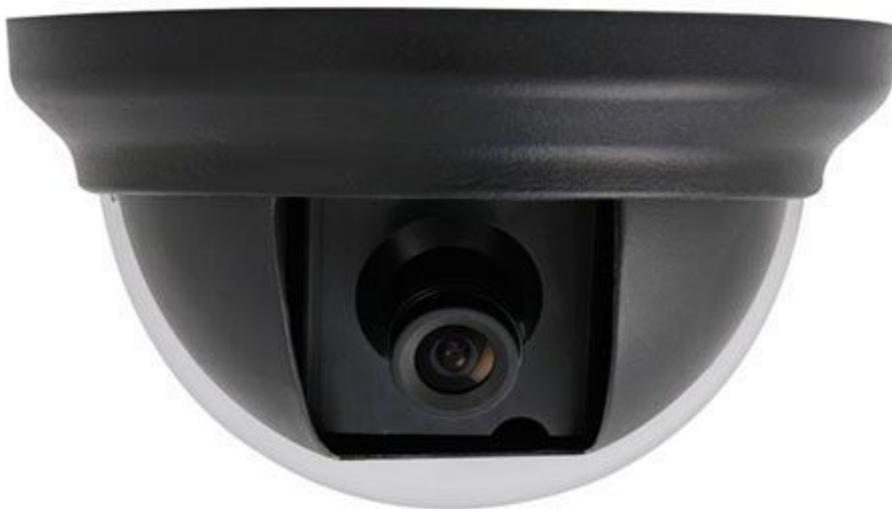
Telecamera a colori con contenitore a cupola per installazioni a soffitto. Dispone di elemento sensibile CCD da 1/3" e vanta una risoluzione orizzontale di 700 linee TV. Sensibilità 0,1 lux / F2.0, Pixel effettivi: 976 (H) x 582 (V) - PAL, f3,6 mm / F2.0, apertura angolare 79°, alimentazione 12 Vdc/110 mA.
