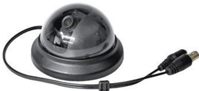
Telecamera a colori con contenitore a cupola per installazioni a soffitto. Dispone di elemento sensibile CCD da 1/3" e vanta una risoluzione orizzontale di 500 linee TV. Sensibilità 0,1 lux / F2.0, 753 x 582 pixel - PAL, ottica f=3,6 mm/F2.0, apertura angolare 79°, alimentazione 12 Vdc/110 mA.
