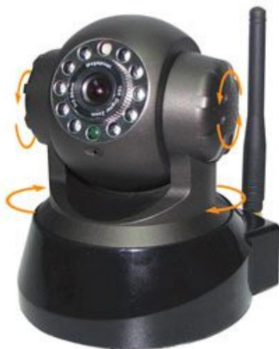
Telecamera IP a colori, motorizzata e con modulo Wi-Fi integrato. Provvista di ottica fissa e brandeggio PAN (270°) / TILT (120°) e dieci led all'infrarosso, che permettono la visione al buio. Ma non si tratta di una semplice telecamera: infatti contiene un processore in grado sia di gestire le riprese, sia di realizzare un vero e proprio sistema d'allarme.
