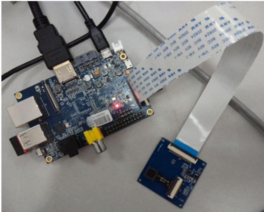
Piccolo modulo per Banana Pi dotato di fotocamera da 5 megapixel (Omnivision 5640). È in grado di scattare foto con una risoluzione di 2592x1944 pixel. Il piccolo modulo, che ha dimensioni di soli 40x40x6,5 mm e pesa 50 grammi, può anche effettuare riprese video HD in formato 1080p a 30 fps, dando la possibilità agli utilizzatori della scheda Banana Pi di realizzare applicazioni video. Il modulo si innesta sul connettore CSI-0 su Banana Pi e si controlla tramite il bus I<sup>2</sup>C.
