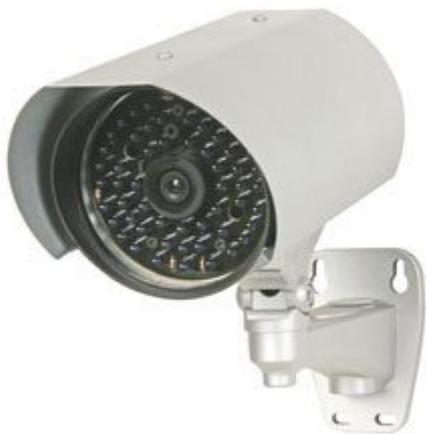
Telecamera a colori da esterno (IP67) con sensore da 1/3" CCD HR a colori. Dotata di ottica f=6.0 mm / F2.0, apertura angolare: 62°, risoluzione di 520 linee TV, 0,1 Lux. L'illuminatore IR, formato da 56 led infrarossi, si attiva automaticamente al buio permettendo una visione ottimale anche di notte o in presenza di scarsissima luce. La telecamera viene fornita completa di staffa di fissaggio in metallo.
