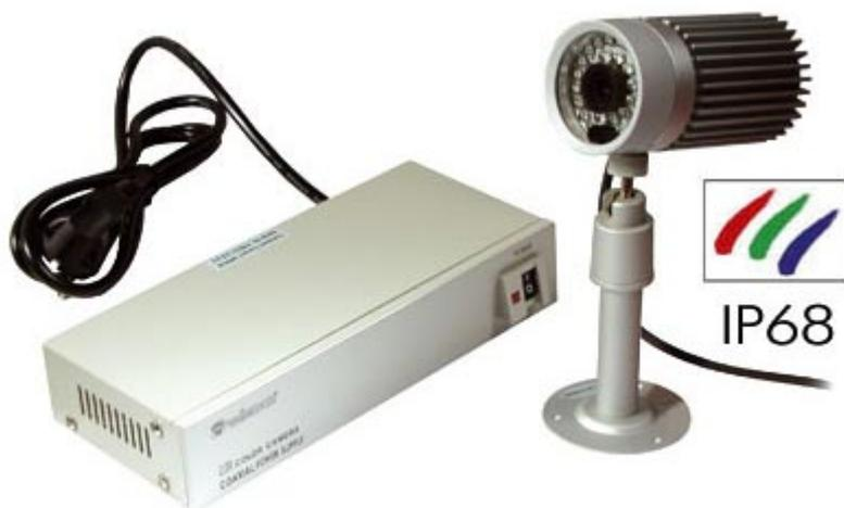
Telecamera subacquea a colori con DSP per impieghi all'interno, esterno ed sott'acqua fino a 30 metri di profondità. Sistema automatico di accensione dei led IR tipo CDS. I led si accendono automaticamente sotto una precisa soglia di luminosità; con i led accesi la telecamera funziona in B/N. Il set comprende, oltre alla telecamera, una staffa di fissaggio, 30 metri di cavo RG58U ed un alimentatore che fornisce tensione tramite lo stesso cavo video.
