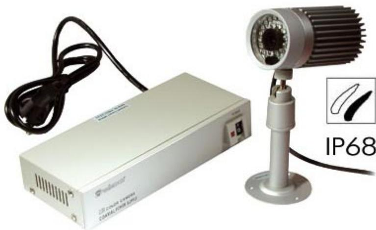
Telecamera subacquea B/N con DSP per impieghi all'interno, esterno e sott'acqua fino a 30 metri di profondità. Sistema automatico di accensione dei led IR tipo CDS. I led si accendono automaticamente sotto una precisa soglia di luminosità. Il set comprende, oltre alla telecamera, una staffa di fissaggio, 30 metri di cavo RG58U ed un alimentatore che fornisce tensione tramite lo stesso cavo video.
