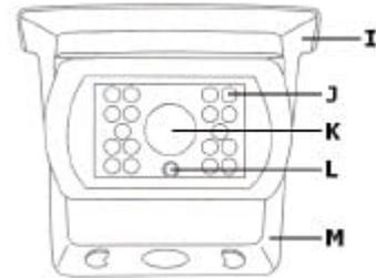
I - parasole / J - LED IR / K - telecamera / L - sensore di luce / M - staffa di montaggio
