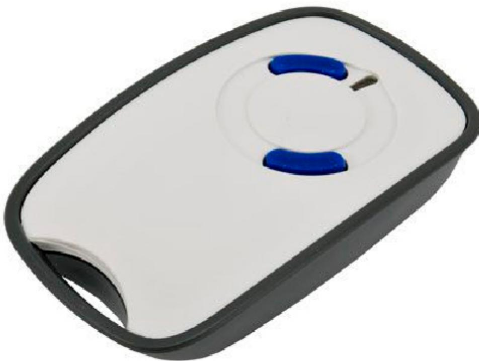
Trasmettitore RF di piccole dimensioni con encoder a codice random e risonatore SAW. Ideale per applicazioni a controllo remoto che richiedano un elevato grado di sicurezza. Abbinabile al decoder MA4. Conforme alle Normative Europee EN 300 220, ETS 300 683, EN 60950. Encoder : HCS301 Microchip Assorbimento: 10 mA @12V, ~1mW E.R.P. Dimensioni (mm): 67x15x40.
