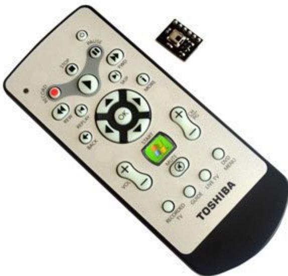
Particolarmente indicato per controllare il vostro media center, basato su Raspberry Pi, questo set è composto da un ricevitore infrarossi che si innesta direttamente sul connettore di Raspberry Pi e da un telecomando IR con portata di 5-8 metri.
