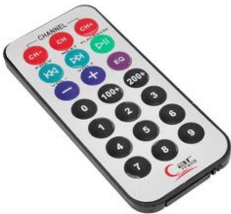
Dotato di 21 pulsanti, questo telecomando a infrarossi, abbinato ad un ricevitore IR, può essere utilizzato per il controllo di un robot, per l'accensione e lo spegnimento di luci o altre dispositivi. Alimentazione: pila 3V (CR2025, inclusa), dimensioni (mm): 86x40x6,4, peso: 78 grammi.
