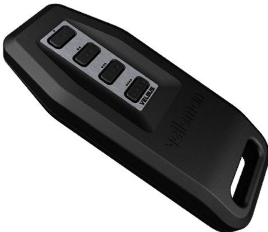
Telecomando IR a 4 canali per controllare a distanza i dispositivi del sistema Velbus. Protocollo: modified RECS80 / 38 kHz carrier, portata: fino a 10 m (con batteria nuova, senza ostacoli e interferenze), alimentazione: batteria 12V tipo V23GA o GP23GAC, dimensioni: 88 x 37 x 13 mm. Compatibile con il modulo pulsanti/timer VMB4PD e con il modulo ricevitore IR VMB8IR.
