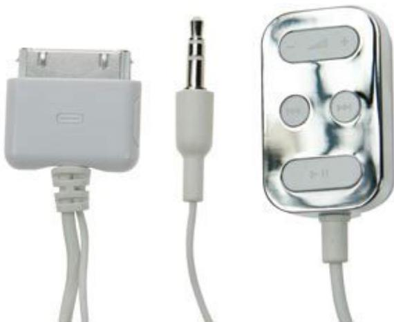
Telecomando per IPOD dotato di cavo con spina Jack stereo da 3,5mm e connettore a 30 pin.
