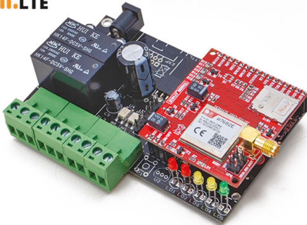
**In modalità SMS:** - Impianti antifurto per immobili civili ed industriali - Impianti antifurto per automezzi - Controllo impianti di condizionamento/riscaldamento - Controllo pompe ed impianti di irrigazione - Controllo impianti industriali - Controllo caldaia **In modalità chiamata voce / apricancello (Uscita 1):** - Apertura cancelli - Controllo varchi - Circuiti di reset
