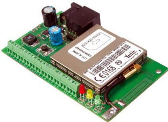
Permette, tramite SMS, di comandare fino a 72 utilizzatori e di leggere altrettanti ingressi digitali, oltre che 2 ingressi analogici. Può funzionare da teleallarme e inviare a un massimo di 8 numeri telefonici un SMS, una telefonata o entrambi, quando gli ingressi rilevano una determinata condizione di allarme. L'accesso al sistema è protetto da password per impedire l'utilizzo da parte di estranei.
