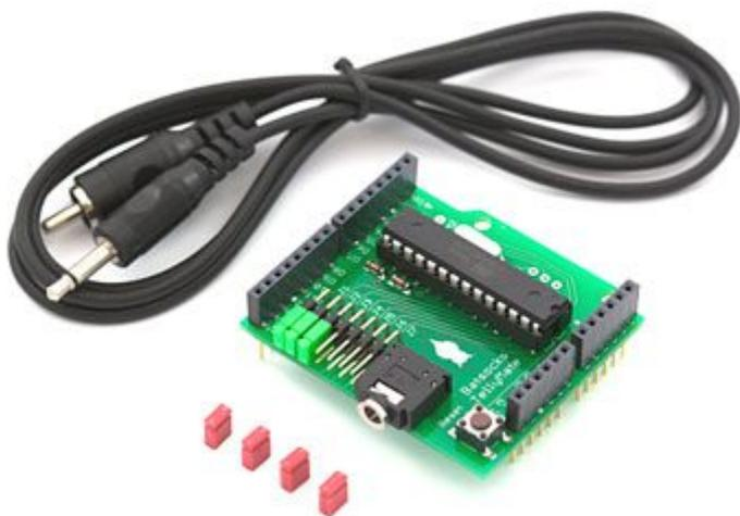
Collegato ad una scheda Arduino e, utilizzando il comando "Serial.println()", permette di inviare semplici testi e grafici sul vostro televisore. La velocità di trasmissione può essere selezionata tramite ponticelli. Arduino utilizza il pin1 (TX) per comunicare con TellyMate.
