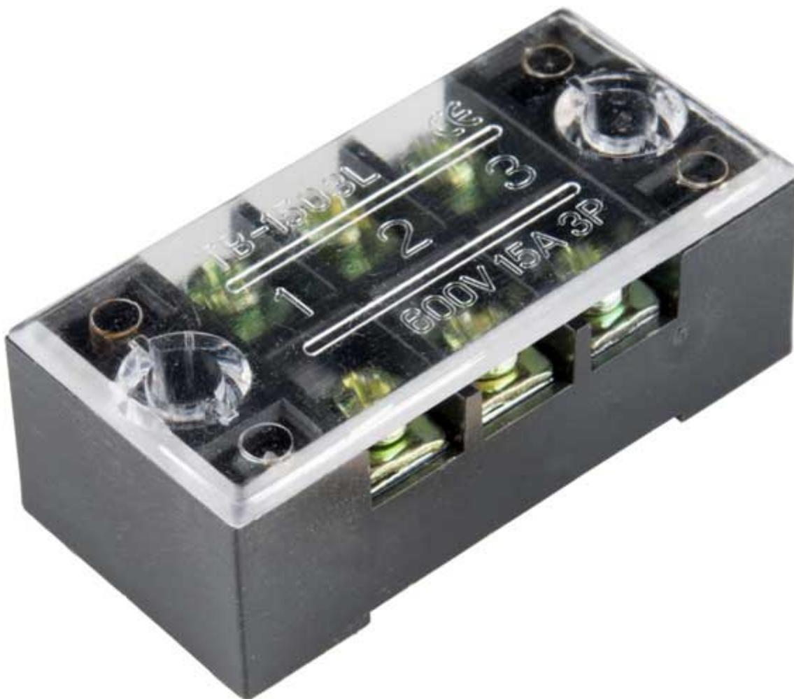
Morsettiera a barriera 3 posizioni doppia fila, serraggio a vite e copertura trasparente di protezione. Permette di collegare in modo semplice e sicuro i cavi ad un unico punto. È in grado di gestire una corrente MAX. di 15 A e una tensione MAX. di 600 VAC. Dimensioni (mm): 45x22x15.
