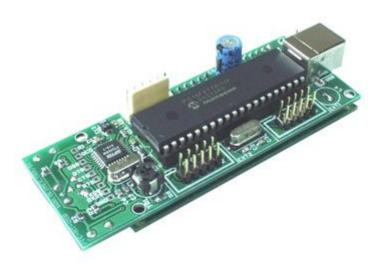
Demoboard predisposta per PIC a 40 pin mediante la quale è possibile testare le proprie applicazioni. Dispone di display LCD 16x2 retroilluminato, porta USB, quarzo a 20 MHz, connettore ICSP/ICD, due pulsanti, un LED bicolore e 16 pin I/O disponibili su connettore. Viene alimentato direttamente dalla porta USB. Dimensioni 95 x 36 mm. **N.B.** la scheda non comprende il microcontrollore PIC.
