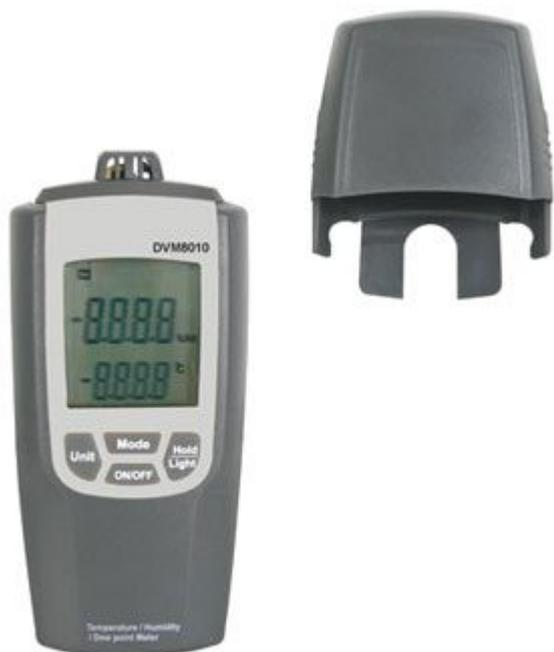
Strumento portatile per la misura della temperatura (da -10°C a +50°C), dell'umidità relativa ambiente (da 0 a 100% RH) e la determinazione del punto di rugiada (Td). Risoluzione 0,1°C - 0,1% RH, alimentazione 3 batterie 1,5 V AAA (incluse).
