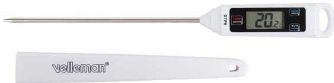
Termometro con sonda in acciaio inossidabile e display digitale adatto per rilevare la temperatura di liquidi e superfici. Scala di misurazione compresa tra -50°C e +330°C. Non necessita di calibrazioni, consente misurazioni estremamente veloci e precise. Dispone di interruttore on/off e pulsante hold. Dimensioni display LCD 27 x 13 mm. Alimentato mediante batteria a bottone (CR1220 - inclusa). Fornito con un pratico astuccio di protezione per il trasporto.
