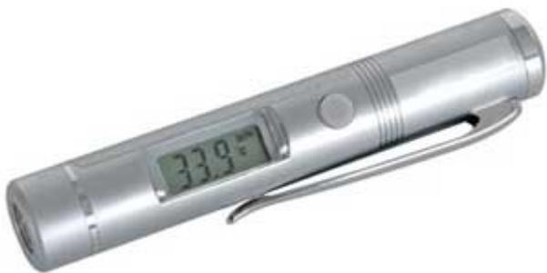
Compatto strumento ad infrarossi per la misura della temperatura a distanza. Dotato di display LCD, di pulsante per la misurazione della temperatura ambiente, di indicazione di batteria scarica, di funzione data-hold e di spegnimento automatico. Gamma di temperatura da -33° a + 220°C. Visualizzazione in gradi centigradi e gradi Fahrenheit.
