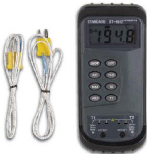
Strumento professionale a 3 1/2 cifre per la misura di temperature da -50°C a 1300°C munito di due distinti ingressi. Indicazione in °C or °F, memoria, memoria del valore massimo, funzionamento con termocoppia tipo K. Lo strumento viene fornito con due termocoppie.
