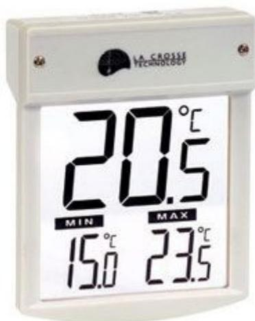
Dispone di ampio display LCD trasparente e si applica direttamente sul vetro esterno della finestra. Visualizza la temperatura esterna (da -29,9°C a +70°C) e il valore della temperatura minima/massima registrato. Resetta automaticamente ogni giorno la temperatura minima alle 20:00 e la massima alle 8:00. Dispone di indicatore batteria scarica. La confezione comprende: termometro e nastro biadesivo per il fissaggio.
