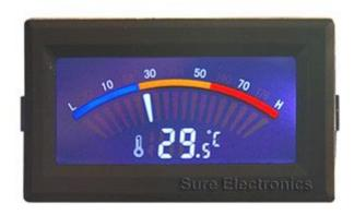
Termometro digitale in grado di misurare temperature comprese tra 0°C e 70°C e dotato di sonda a tenuta stagna. Possibilità di visualizzare la temperatura in °C e °F, precisione: +/-1°C, lunghezza del cavo di alimentazione: 40 cm, lunghezza del cavo della sonda: 60 cm. Dimensioni (mm): 48 x 28 x 17, peso: 80 grammi. Alimentazione: 5 Vdc. Può essere alimentato direttamente tramite il connettore a 4 pin del PC.
