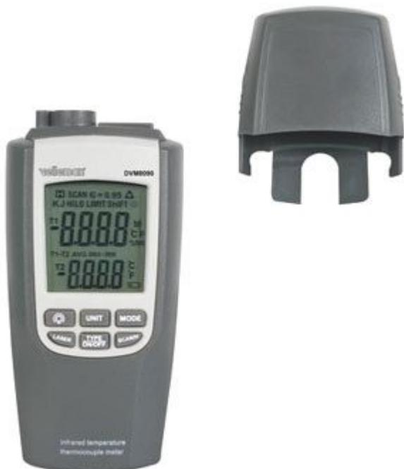
Sistema ad infrarossi per la misura della temperatura con o senza contatto (termocoppia o infrarossi). Dispone di puntatore laser, memoria display (visualizza i valori misurati più alti, più bassi e la differenza tra i due), auto spegnimento e indicatore di batteria scarica. Range di temperatura: da -50 a +300°C (da -58°F a 572°F) con infrarossi, da -200 a +1300°C (da -328°F a 2372°F) con termocoppia.
