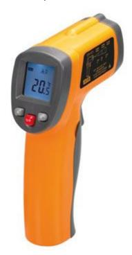
Termometro a infrarossi senza contatto che permette di eseguire rapide e accurate letture della temperatura (da -32°C a +350°C). Dispone di puntatore laser, display LCD con retroilluminazione, visualizzazione in gradi centigradi o in gradi Fahrenheit, risoluzione 0,1°C / 0,2°F, indicatore di batteria scarica, auto spegnimento. Alimentazione: batteria 9V (inclusa).
