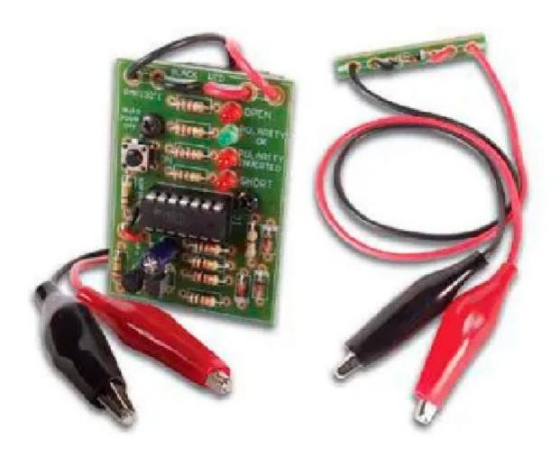
Verifica la continuità dei cavi e identifica i singoli fili. Ideale per controllare la polarità dei cavi degli altoparlanti. Indicazione LED per circuito aperto, cortocircuito e polarità corretta/sbagliata. Funzionamento a pulsante con spegnimento automatico.
