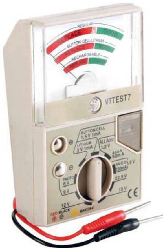
Utile strumento analogico che permette di controllare rapidamente lo stato di carica di vari tipi di batterie. Dimensioni (mm): 100x64x33, peso: 85 grammi.
