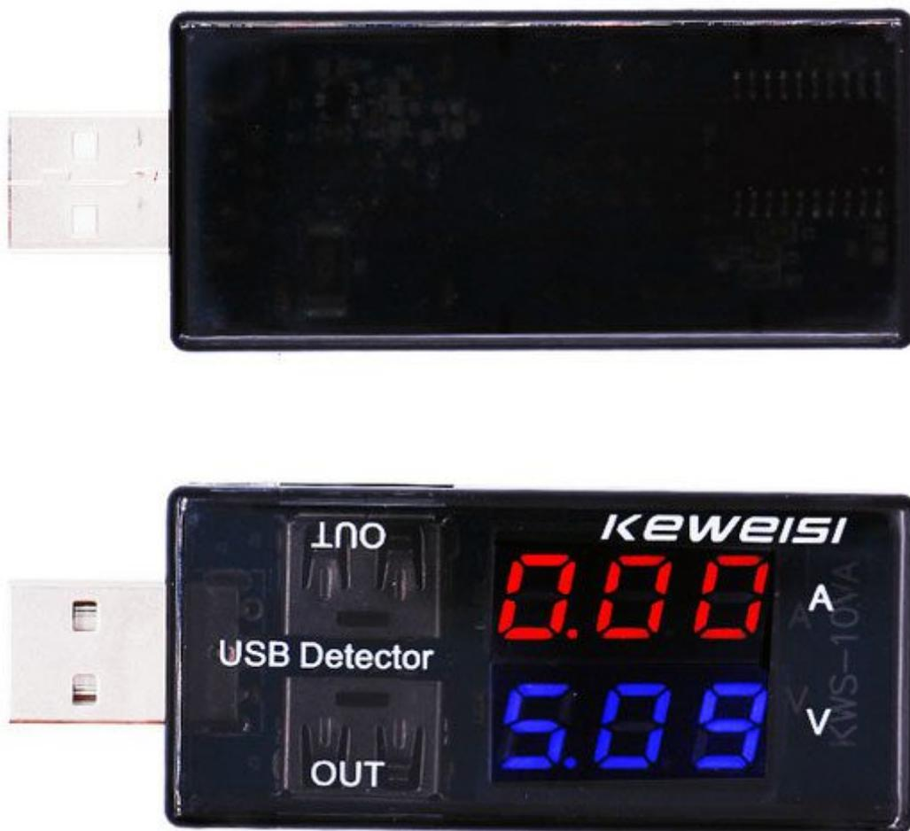
Collegato alla porta USB di un alimentatore o di un PC, visualizza in tempo reale sul display a LED di cui dispone, la tensione presente in ingresso e la corrente assorbita dal dispositivo USB ad esso collegato. Dispone di due connettori di uscita USB femmina tipo A, un display a LED rossi per la corrente e un display a LED blu per la tensione. Particolarmente indicato per alimentare o ricaricare la batteria di cellulari, tablet, ecc. Dimensioni (mm): 73,6x28,4x14,8; peso: 23 grammi.
