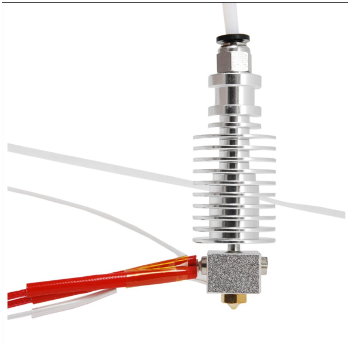
Completa testina di stampa per DMake (E3DV5) utilizzabile con filamenti da 1,75 mm. Dotata di corpo in alluminio, ugello in ottone con foro da 0,4 mm, riscaldatore da 40 watt, NTC da 100 kohm, tubo in PTFE (Teflon) lungo circa 1 metro e cavi di collegamento lunghi circa 90 cm, peso: circa 88 grammi.
