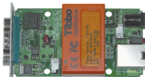
Vista interna del Serial Device Server DS100B Il cuore del dispositivo è il modulo EM100
