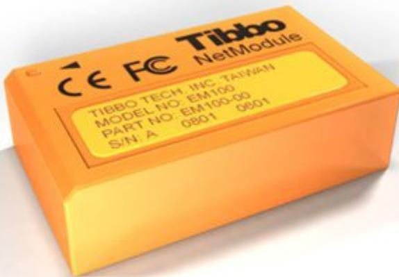
Modulo che consente di collegare ad una LAN Ethernet qualsiasi apparecchiatura munita di porta seriale RS232. Dispone di un indirizzo IP proprio facilmente impostabile tramite la LAN o la porta seriale. Questo dispositivo consente di realizzare apparecchiature "stand alone" per numerose applicazioni in rete.
