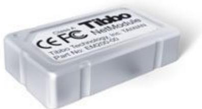
Si differenzia dagli altri moduli Tibbo per la disponibilità di una porta Ethernet compatibile 100/10BaseT e per le ridotte dimensioni (32.1 x 18.5 x 7.3 mm). Il modulo è pin-to pin compatibile con il modello EM120 ed utilizza lo stesso software messo a punto per tutti gli altro moduli di conversione Ethernet/seriale. L'hardware non comprende i filtri magnetici per la porta Ethernet. Dispone di due buffer da 4096 byte e supporta i protocolli UDP, TCP, ARP, ICMP (PING) e DHCP.
