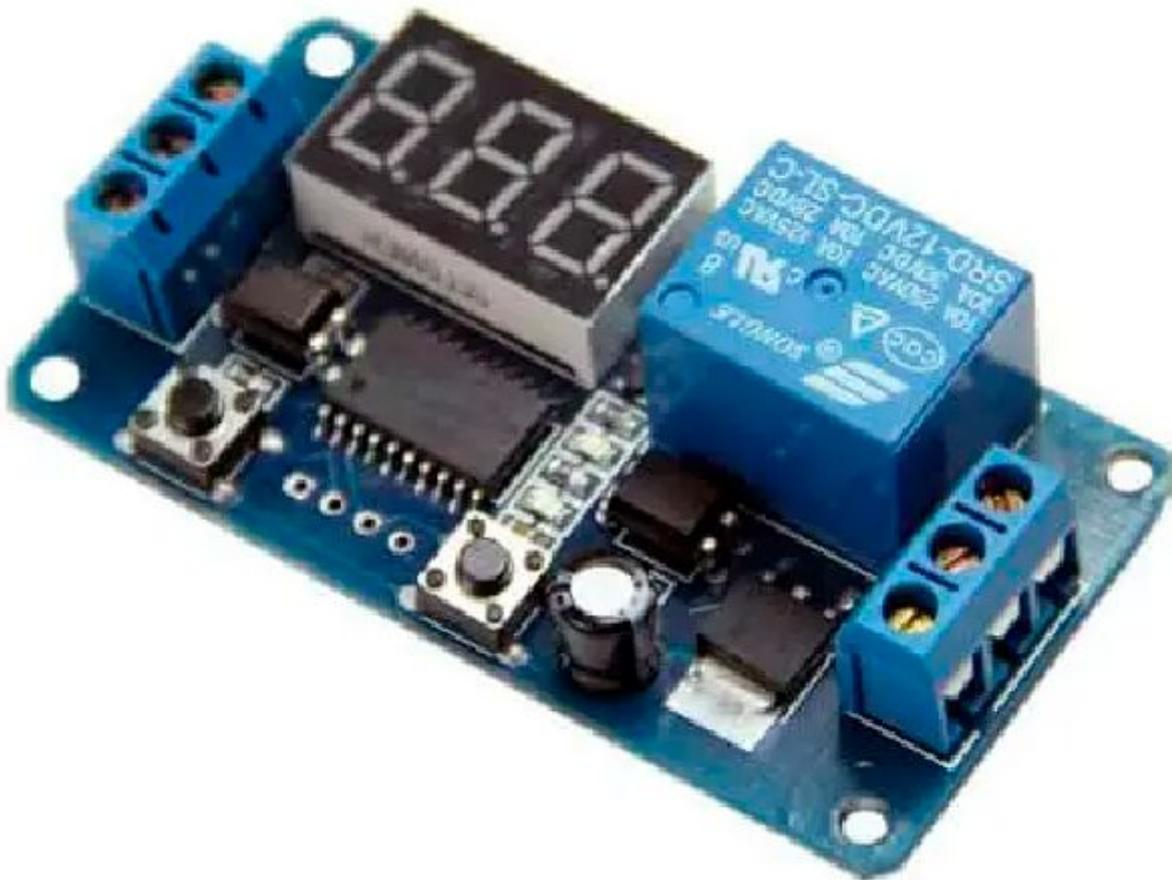
Timer countdown da 999 secondi con display a 3 cifre a LED rossi. Dispone di 2 pulsanti per l'impostazione del tempo, 2 LED di stato, 1 relè di uscita in grado di commutare carichi massimi da 250 Vac/2 A e 30 Vdc / 10 A. Il tempo impostato viene mantenuto anche in caso di mancanza di alimentazione. Il countdown si attiva fornendo +12 Vdc al piedino "IN". Alimentazione: 12 Vdc, dimensioni (mm): 67x36x17,5 mm.
