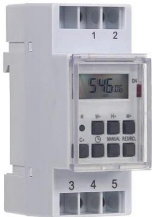
Timer digitale con display LCD per montaggio su guida DIN. Ideale per fornire o togliere l'alimentazione a vari generi di apparecchiature elettriche secondo il tempo desiderato e ad orari prestabiliti siano essi giornalieri o settimanali. Alimentazione 230Vac, doppio relè, permette di pilotare 2 carichi fino a 16A, 3600W.
