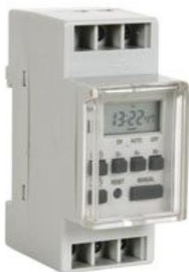
Timer digitale in grado di eseguire otto programmi giornalieri e settimanali. Dispone di display LCD (visualizza ora e giorni della settimana), batteria di backup interna (ricaricabile NiMH) che consente il mantenimento dei dati fino a 200 ore in caso di mancanza di alimentazione. Modalità di funzionamento: on - off - auto. Contenitore con grado di protezione IP30 e coperchio trasparente bloccabile. Montaggio su guida DIN o parete. Alimentazione: 220 Vac.
