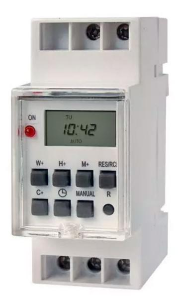
Timer digitale con display LCD per montaggio su guida DIN. Ideale per fornire o togliere l'alimentazione a vari generi di apparecchiature elettriche secondo il tempo desiderato e ad a orari prestabiliti siano essi giornalieri o settimanali. Carico max. 3680 watt 16 A, alimentazione 230 VAC.
