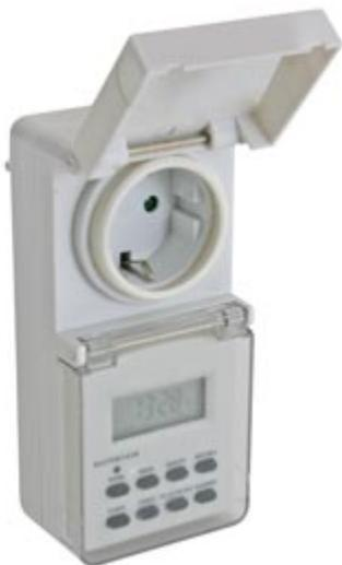
Consente di accendere e spegnere apparecchiature elettriche nei giorni e nelle ore della settimana prestabilite. Dispone di 10 programmi di funzionamento per ciascun giorno della settimana con step di regolazione di 1 minuto, tasto On/Off, formato dell'orario 12/24 ore, funzione di regolazione automatica dell'ora legale, presa di tipo SHUKO. Adatto per impieghi all'esterno (IP44).
