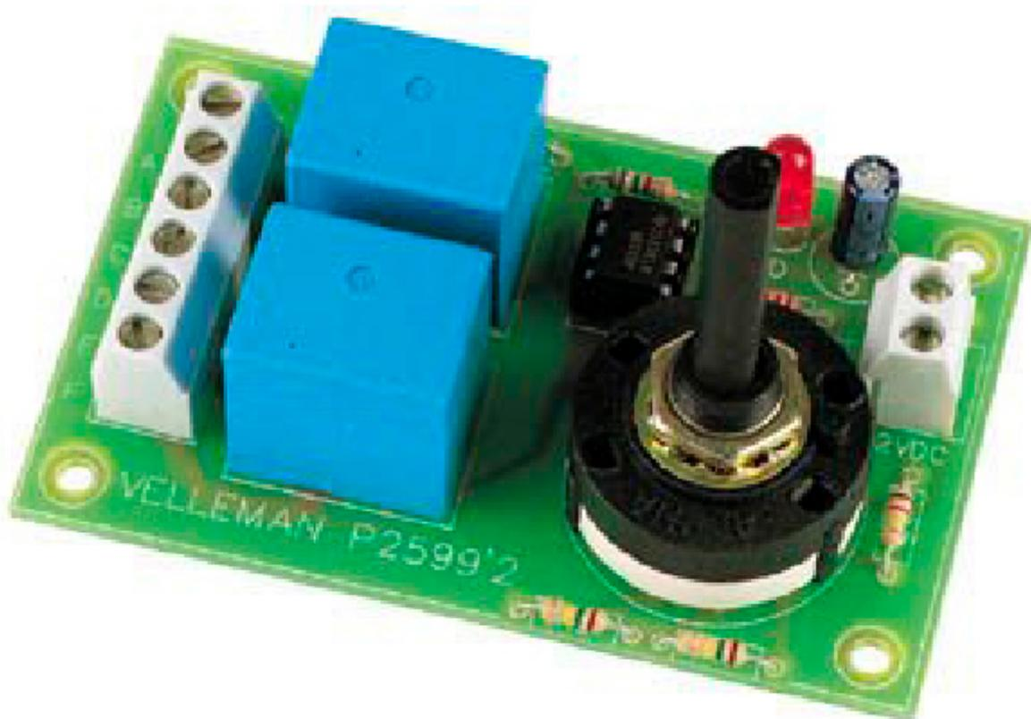
Per il funzionamento delle spazzole tergicristallo della tua auto possono essere selezionati sino a tre diversi intervalli di tempo (2 - 10 - 15 secondi). Il circuito può anche essere usato per la proiezione automatica di diapositive. Il manuale contiene istruzioni di installazione per più autovetture.
