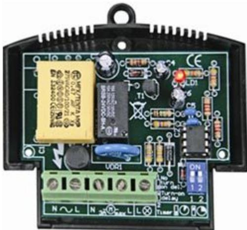
Ideale per l'accensione e lo spegnimento temporizzato di ventole d'aspirazione in bagni e cucine. Permette, tramite un singolo tasto, di accendere la luce e attivarne il funzionamento. Funzione di spegnimento e accensione automatico della ventola con ritardo regolabile.
